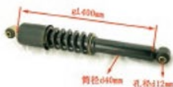
4621-7115121 驾驶室减震器(后) cab shock absorber
