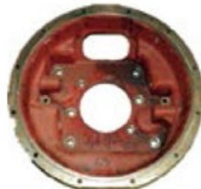
9001-3611111 离合器壳(配STR*A-3674) clutch housing
