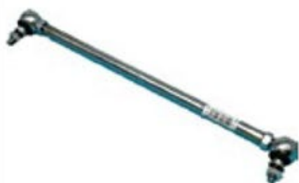
6001-7342217 中门自动泵拉杆总成 (下*外摆*外牙) middle door auto pump linkage assy
