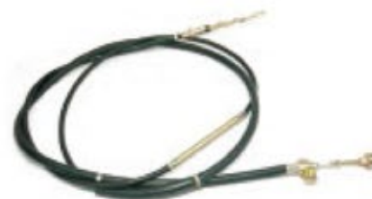
5000-4512516 手刹线 park cable
